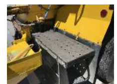
防滑塗装施工例 （ミキサー車ステップ）
