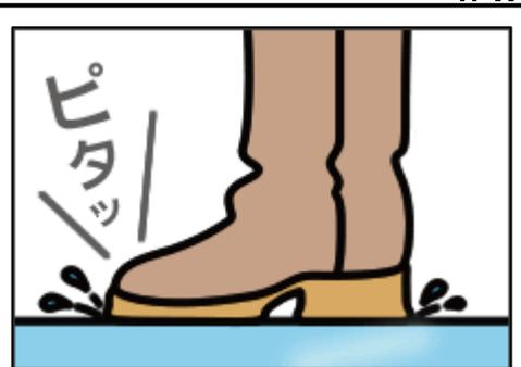
柔らかいゴムを使った靴底は、路面に対する接着力が強いので滑りにくくなっています。
