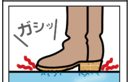
滑り止め材が混ざっている靴底は、ヤスリのように路面をひっかくので、より滑りにくくなっています。
