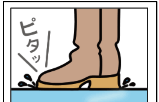
柔らかいゴムを使った靴底は、路面に対する接着力が強いので滑りにくくなっています。
